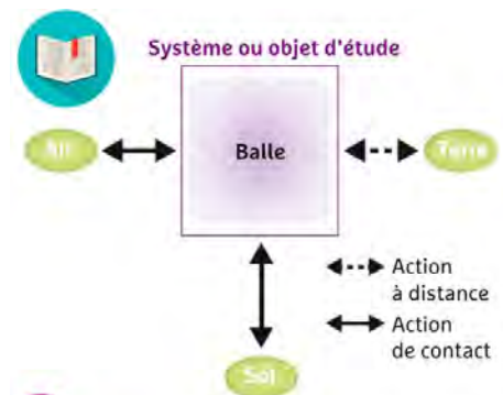
3 Diagramme objet-interactions. Il permet de faire le bilan des interactions auxquelles le système étudié est soumis.
